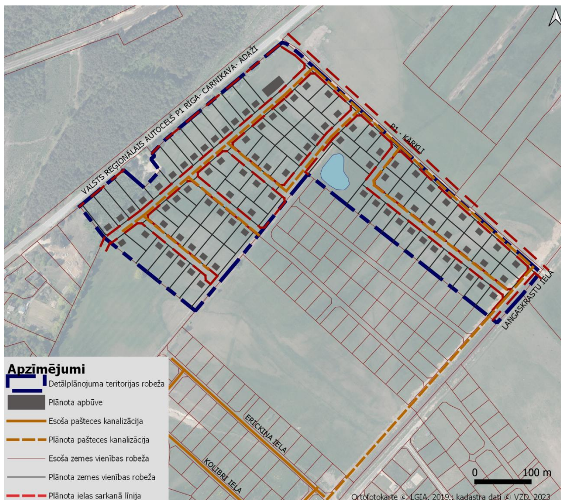
31. attēls. Detālplānojuma teritorijas saimnieciskās kanalizācijas shēma
