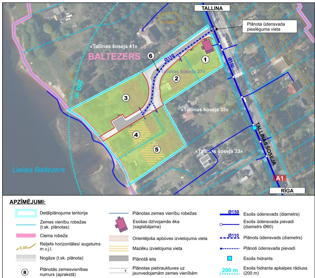
Attēls 11. Plānotie ūdensapgādes risinājumi
