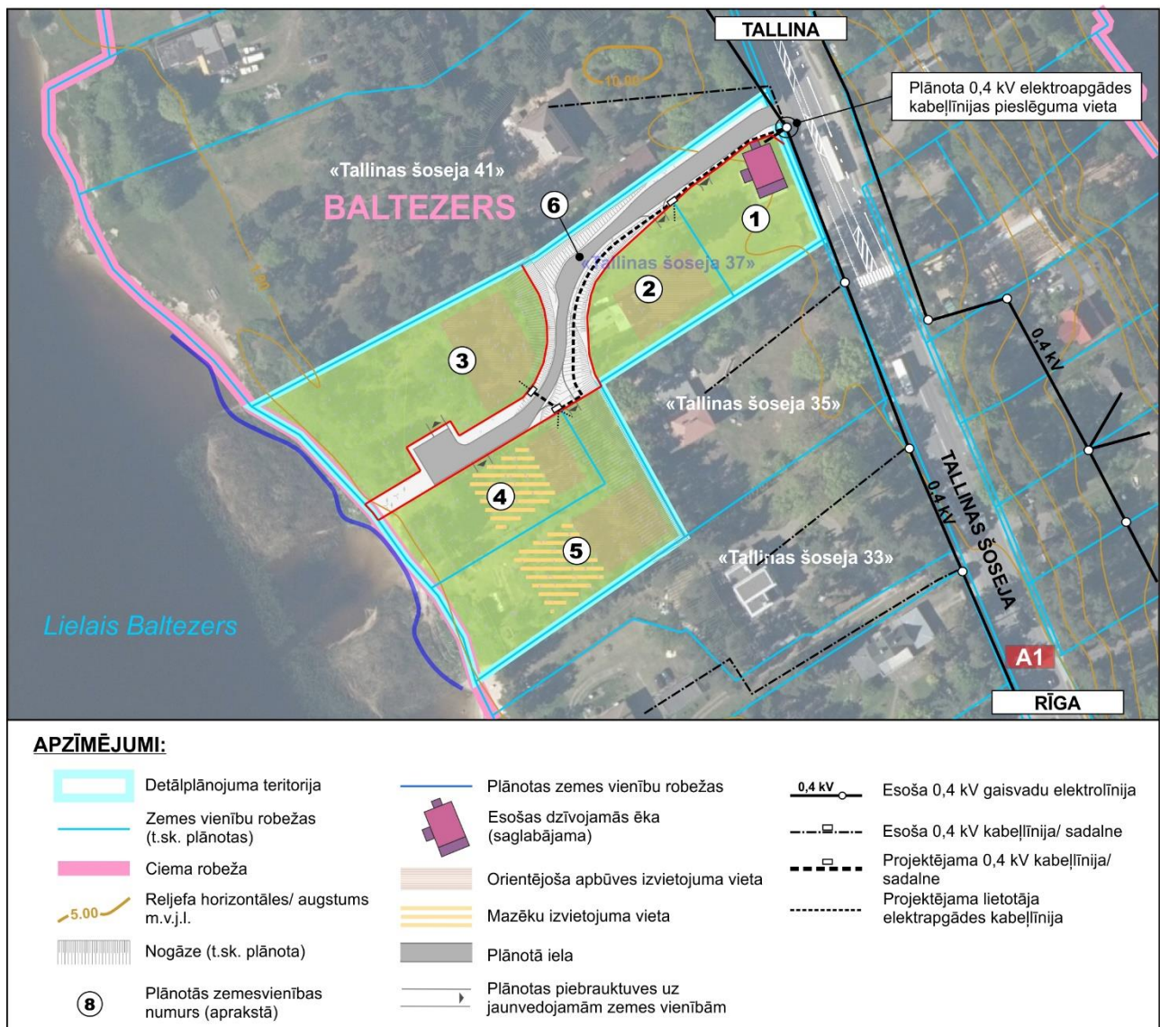
Attēls 12. Plānotie elektroapgādes risinājumi
