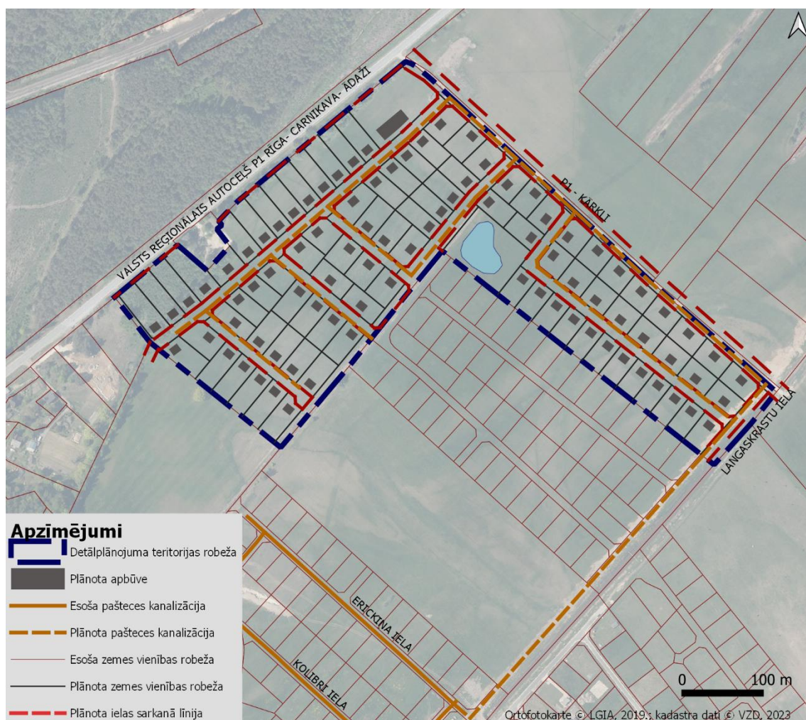
31. attēls. Detālplānojuma teritorijas saimnieciskās kanalizācijas shēma
